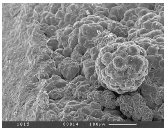
Фиг. 59. Еще один тип сложения руды — шаровидные колонии из кокковидных форм
