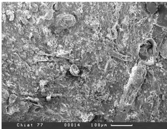
Фиг. 3–8. Вид общей фосфатной массы фосфорита при разных увеличениях. Отчетливо видно, что она сложена хаотической массой различных фосфатизированных органических остатков
