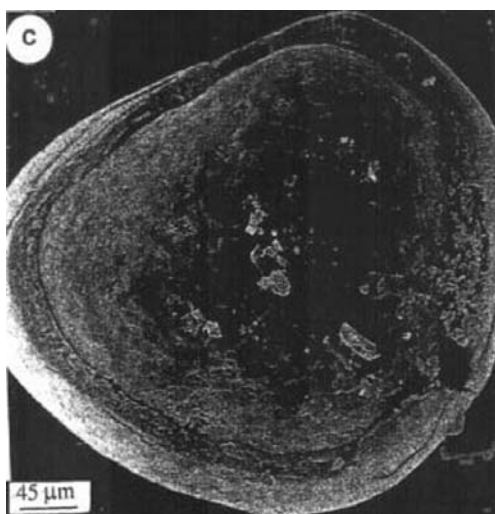
Фиг. 1. Черное зерно с варьирующими Fe-Mn корковыми слоями. Вид в СЭМ и далее
