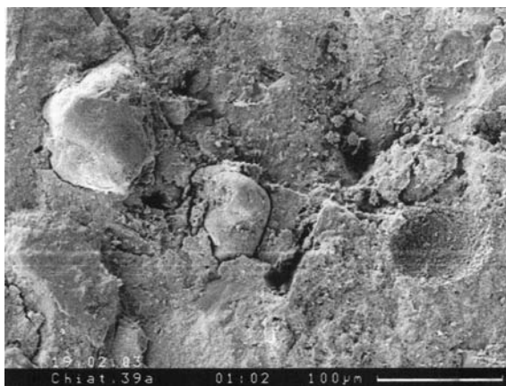
Фиг. 23 и 24. Общий вид обр. 39a-1, состоящего из полуокатанных до окатанных рудных обломков разной величины
