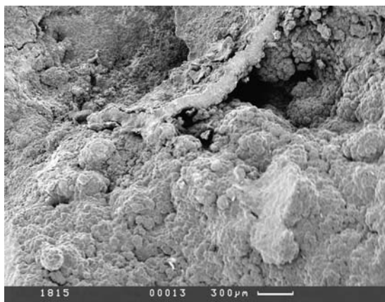
Фиг. 48–50, 52. Структура основной массы руды из шаровидных тел диаметром до 40–60 мкм
